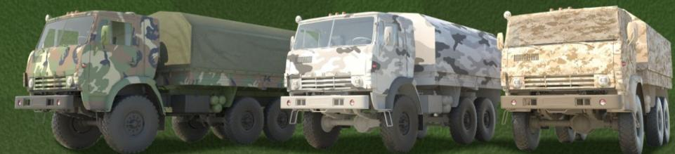
Специальные чехлы для хранения и консервации техники позволяют контролировать уровень влажности, а также служат в качестве защитного и маскировочного покрытия.
